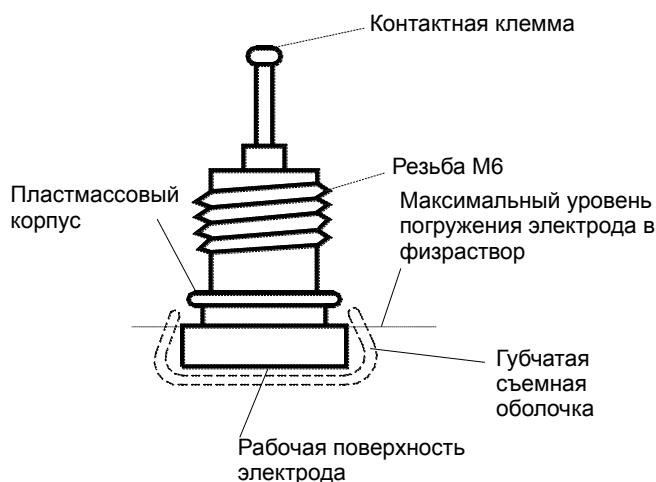
Рис.1. Внешний вид электрода электроэнцефалографического
